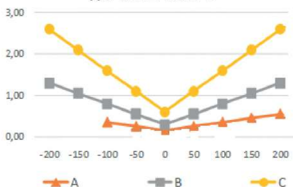
Предельные отклонения от НСХ датчиков ТСПТ-Б
