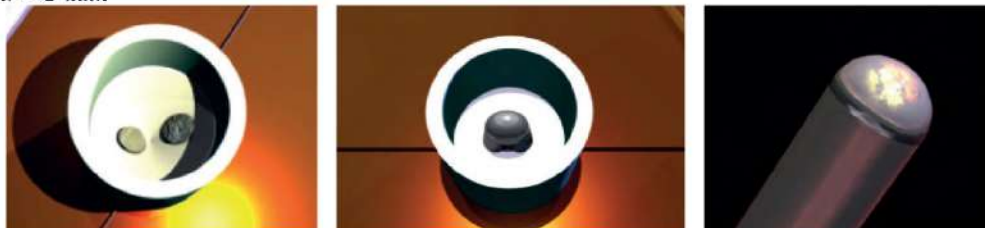
Рис. 5. сварка кабельной термопары
