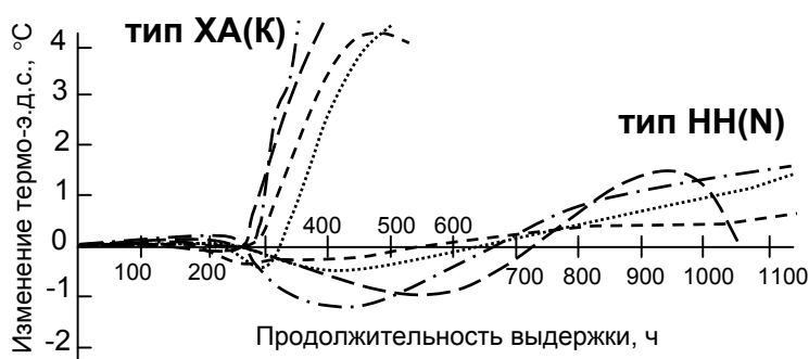
Рис.22 Сравнительная стабильность кабельных термопар НН и ХА в жаростойких оболочках Nicrobell-B при температуре 1280 °С. Данные компании Nicrobell Pty. (Австралия) [32].
